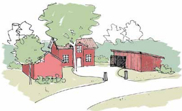
Boningshuset ligger indraget från vägen med en till tomten anpassad placering. Uthusen underordnar sig boningshuset. Varierande takhöjd och siluett skapar en dynamisk anpassad gårdsmiljö. Mjuk vegetation av naturkaraktär ansluter till det omgivande landskapet. Av Ezequiel Pinto-Guillaume.
