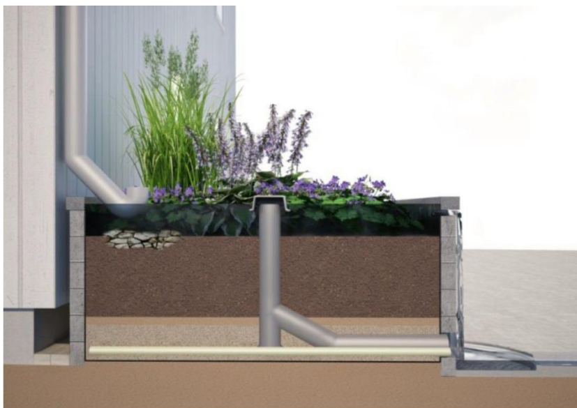
Figur 39. Principskiss på upphöjda växtbäddar (Bildkälla: Kent Fridell och Kristian Klasson, Tengbomgruppen AB.)
