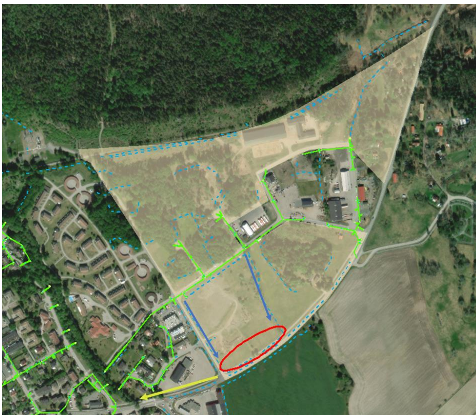
Figur 52. Potentiell placering av dagvattenåtgärd (i rött) inom Norrtäljeån-Vallbyåns tekniska avrinningsområde. Utbyggnad av verksamhet- och industriområde i ljusgult. Dagvattnets transportväg till anläggningen visas med blå pilar och från anläggningen med gul pil.
