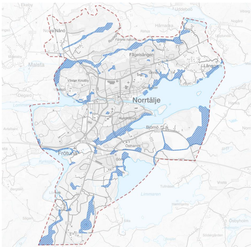
Figur 26. Föreslagna ytor för vattenvård, dagvatten- och översvämningshantering.
