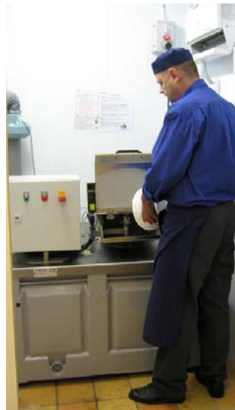
Figur 12: NanoVac matavfallskvarn med sluten tank. Källa: Action
