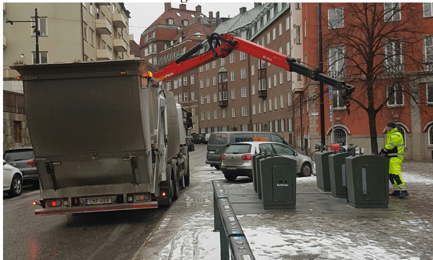
Figur 5 Exempel kranbilstömning bottentömmande underjordsbehållare.
