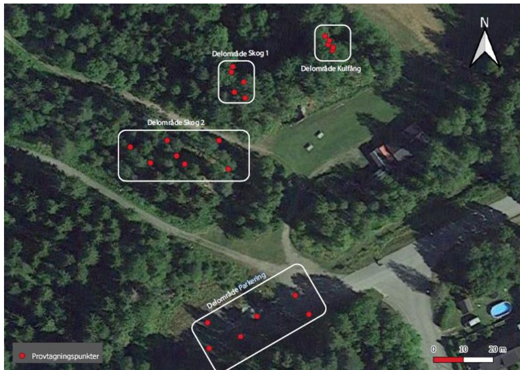
Figur 10. Delområden för provtagning och provtagningspunkter (Miljöteknisk markundersökning, Trapezia 2019).
