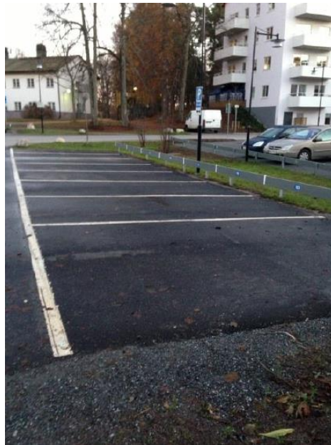
Figur 13. Parkeringsplats anlagd med asfalt. Dagvatten avrinner till grönstråk i mitten av parkeringen då asfaltsytan är lutad så. Lösningen leder till minskad avrinning inom området och rening av dagvatten. Denna grönyta är inte skålad.
