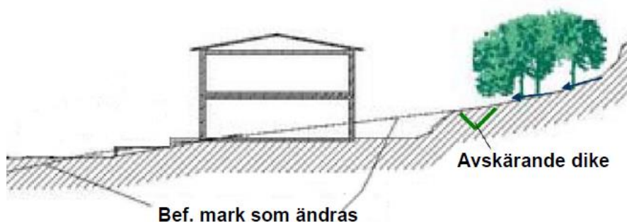
Figur 19. Principskiss över avskärande dike vid tomtgräns för avledning av dagvatten från omgivande mark som ligger högre än planområdet.
