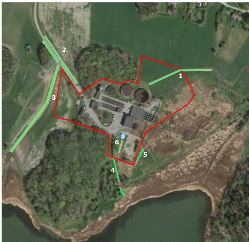
Figur 5-9 Grön- och gulmarkerade linjer motsvarar befintliga diken, rosa linjer motsvarar trummor och blå oval motsvarar befintlig dagvattendamm som samlar upp oljeprodukter (Ramboll, 2023a).
