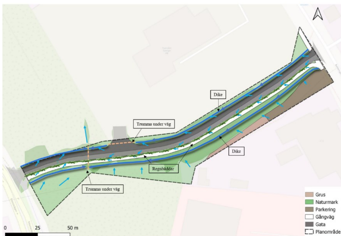
Figur 18. Schematisk skiss på föreslagen dagvattenhantering genom regnbäddar, diken och trummor för den nya vägen. Bakgrundskarta: OpenStreetMaps bidragsgivare (2024).
