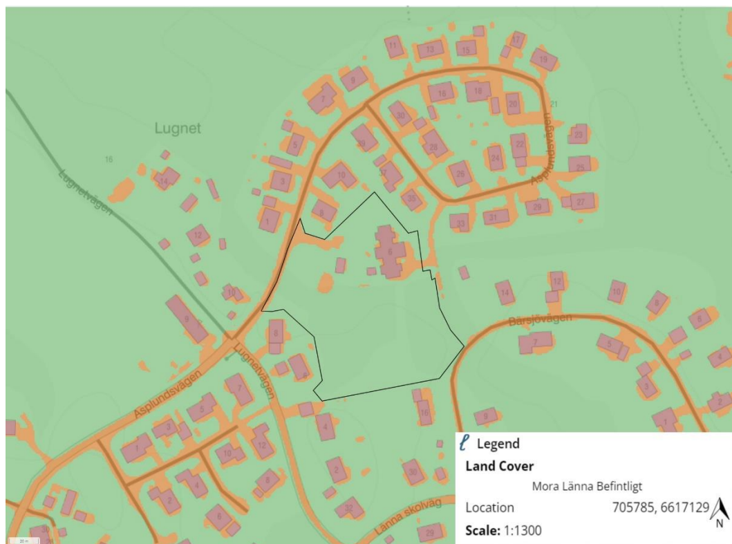
Figur 23. Genomsläppligheten för markytan i det nuvarande scenariot, där rött representerar tak, orange är ogenomträngliga ytor (främst vägar) och grönt är genomsläppliga områden (som gräs och skog). Svarta linjer visar utredningsområdet.
