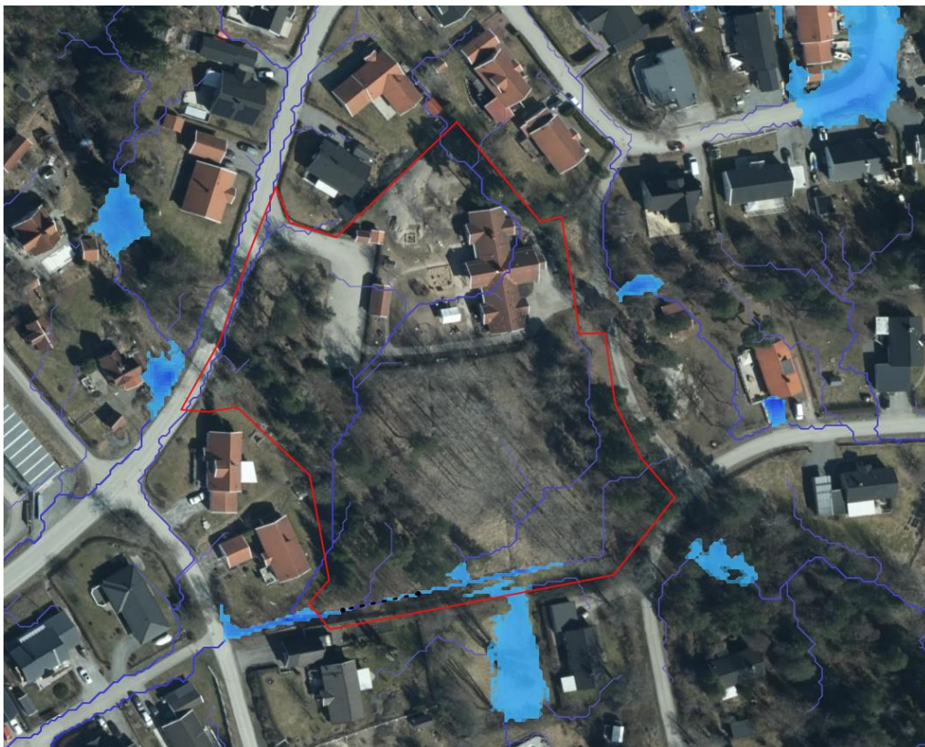
Skyfallsscenario vid befintlig situation, 10 cm nederbörd
