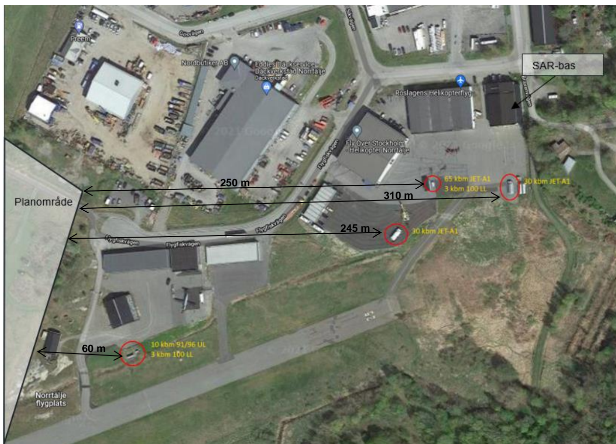
Figur 6. Förvaring av brandfarlig vara inom Mellingeholm flygplats såsom det ser ut i nuläget i relation till planområdet. Längst till höger i bilden ses Sjöfartsverkets SAR-bas tankanläggning om 30 m 3 [13]
