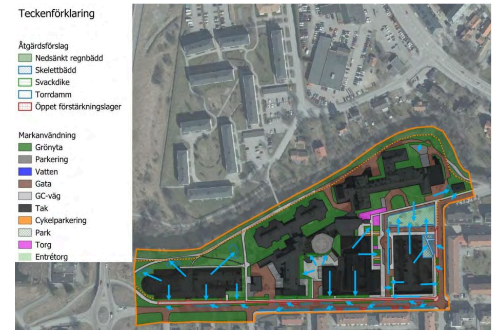
Principiella avrinningsvägar till föreslagna dagvattenåtgärder.
