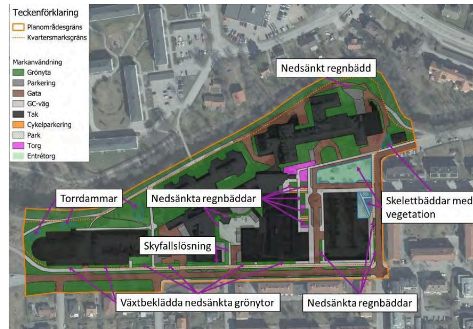
Förslag på lokalt omhändertagande av dagvatten inom den kvartersmark som byggs om.
