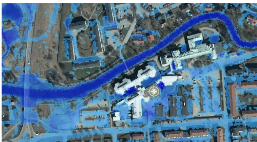
Områden som idag riskerar bli stående med vatten över 10 cm vid ett 100-årsregn. Källa: Dagvattenutredning, WRS, 2026-03-27.
