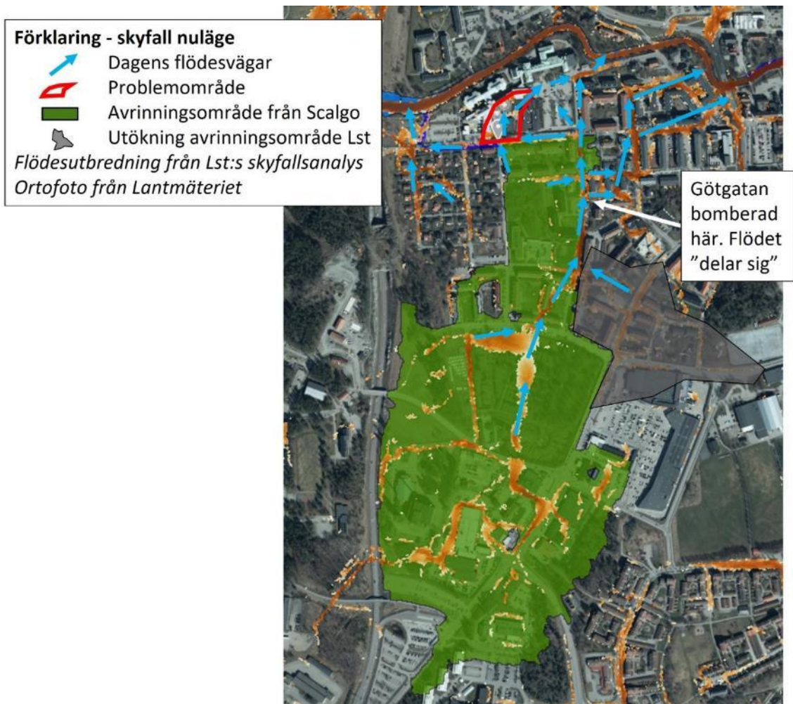
Figur 17. Avrinningsområde och flödesvägar för skyfallsflöden som passerar genom planområdet. Modell av Sweco (2020) på bakgrund © Lantmäteriet. Figur framtagen i Scalgo (2025).
