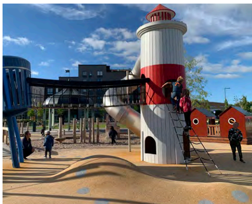
Figur 413. Olika typer av fallskydd blandas för att öka tillgängligheten. Bildkälla: Sydväst
