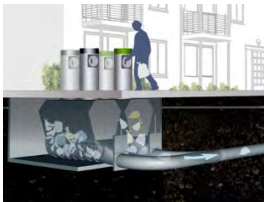
Figur 127. Principvy sopsugssystem, ovan och under mark. Bildkälla: Envac
