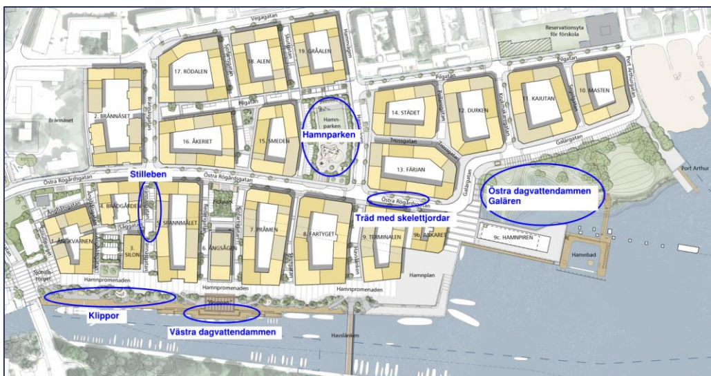
Figur 6. Bilden visar typexempel på de olika de olika ytor/funktioner som används för dagvattenhantering inom allmän plats (samma typ av lösningar finns inom fler gaturum och parker). (Bild: Sydväst arkitektur och landskap)
