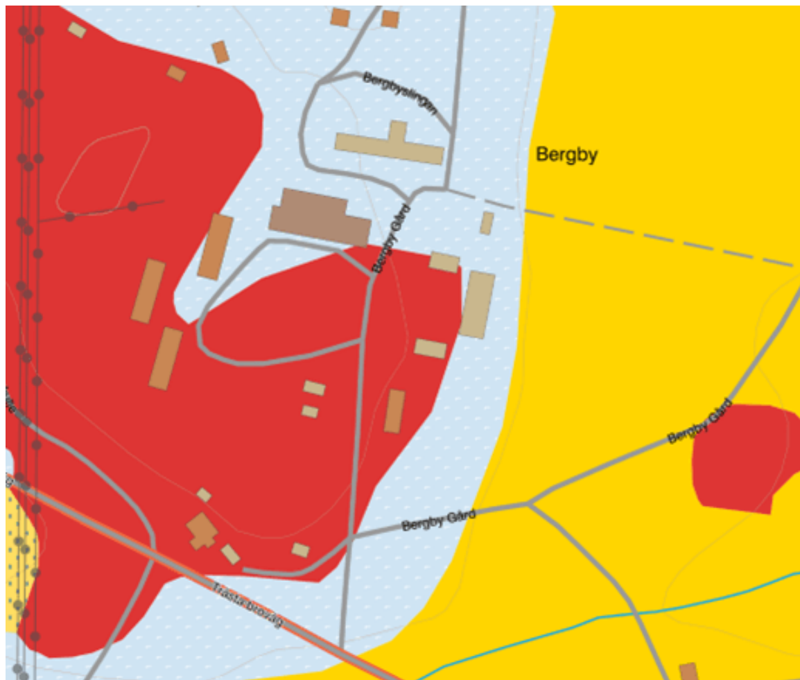
Figur 15: Röd färg betyder berg i dagen eller nära markytan. Ljusblått med hakar betyder lerig morän och gul färg glacial lera, karta: Sveriges Geologiska Undersökning SGU.
