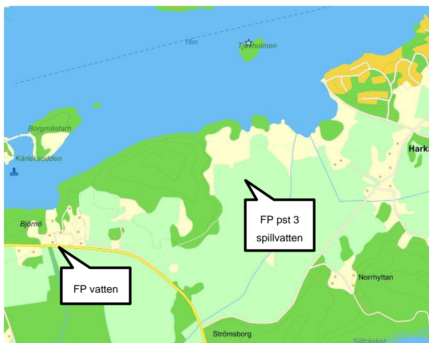
Bild 3: Förbindelsepunkter vatten och spillvatten
