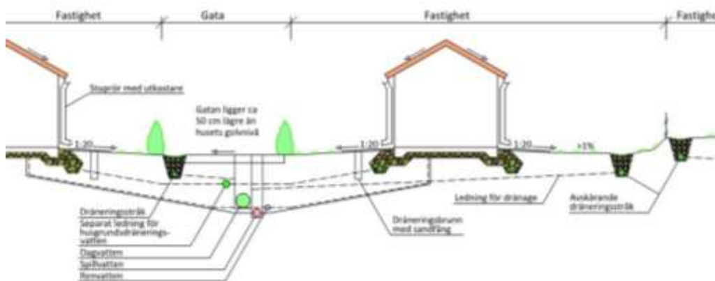
Figur 7. Exempel skiss över trög omhändertagning av dagvatten vid fastigheter. Utdrag från Figur 9.6 från svenskt vattens publikation P105.
