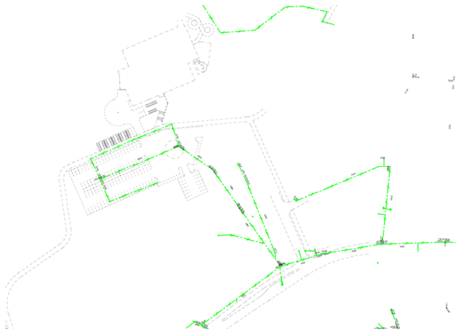
Figur 6: Ledningskarta befintliga dagvattenledningar
