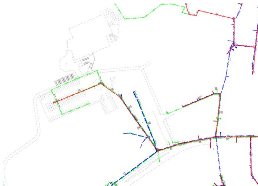
Figur 5: Ledningskarta befintligt VA
