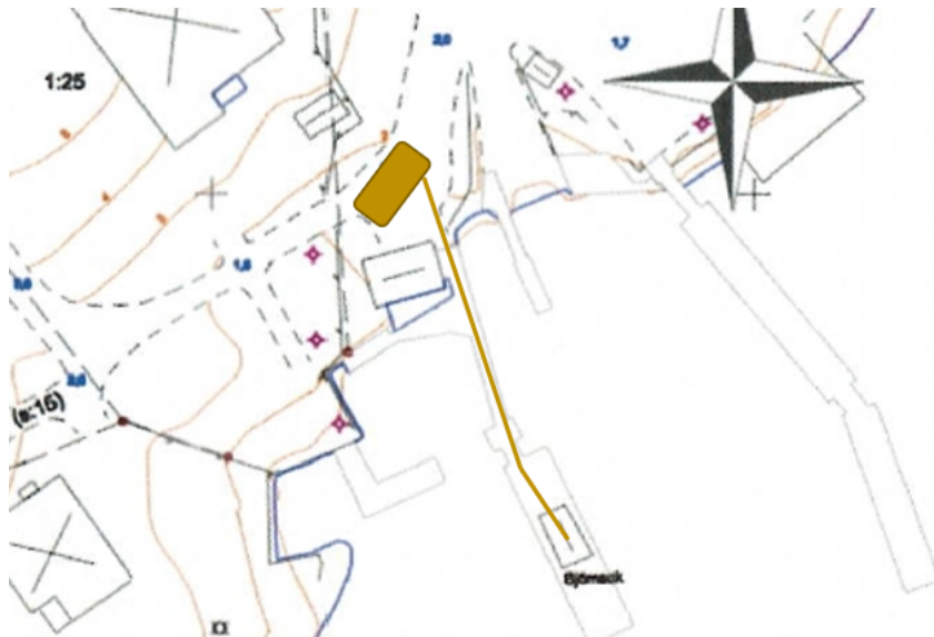
Bild 2) Placering av tankbil samt slang (markerat brunt) vid påfyllning av cisterner
