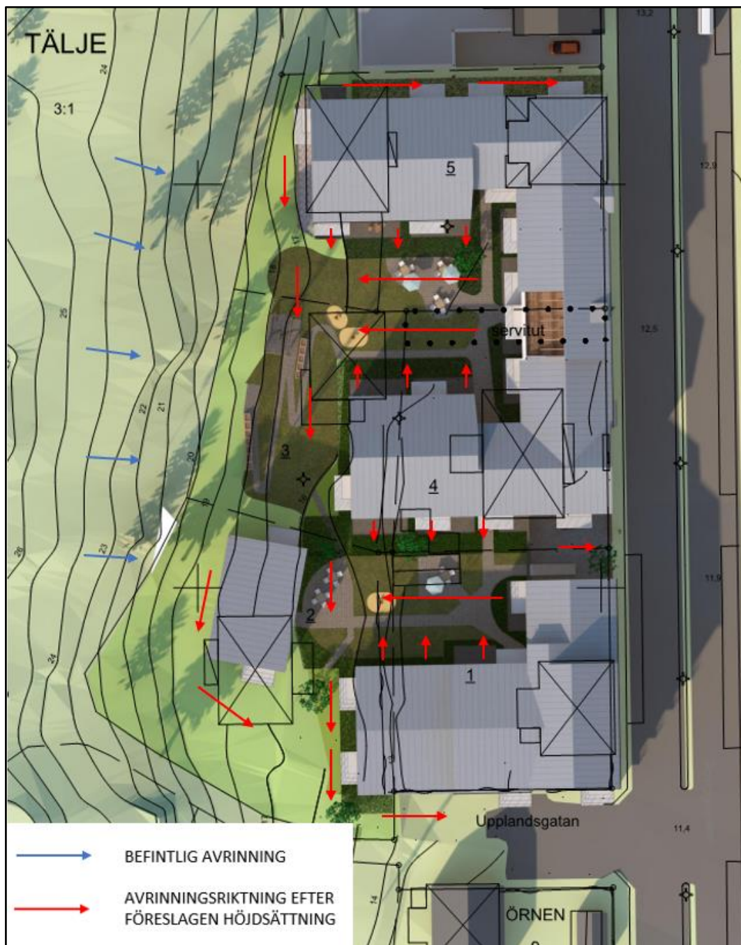
Figur 12 Planerad yttlig avrinning vid skyfall inom planområdet efter föreslagen höjdsättning (röda pilar), samt befintlig yttlig avrinning utanför planområdet (blå pilar).
