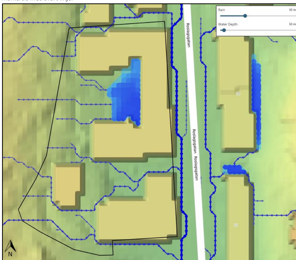
Figur 7 Översvämmad yta (med djup > 5 cm) med hänsyn till ny byggnad vid 50 mm regn. Plangränsen är markerad med svart linje.
