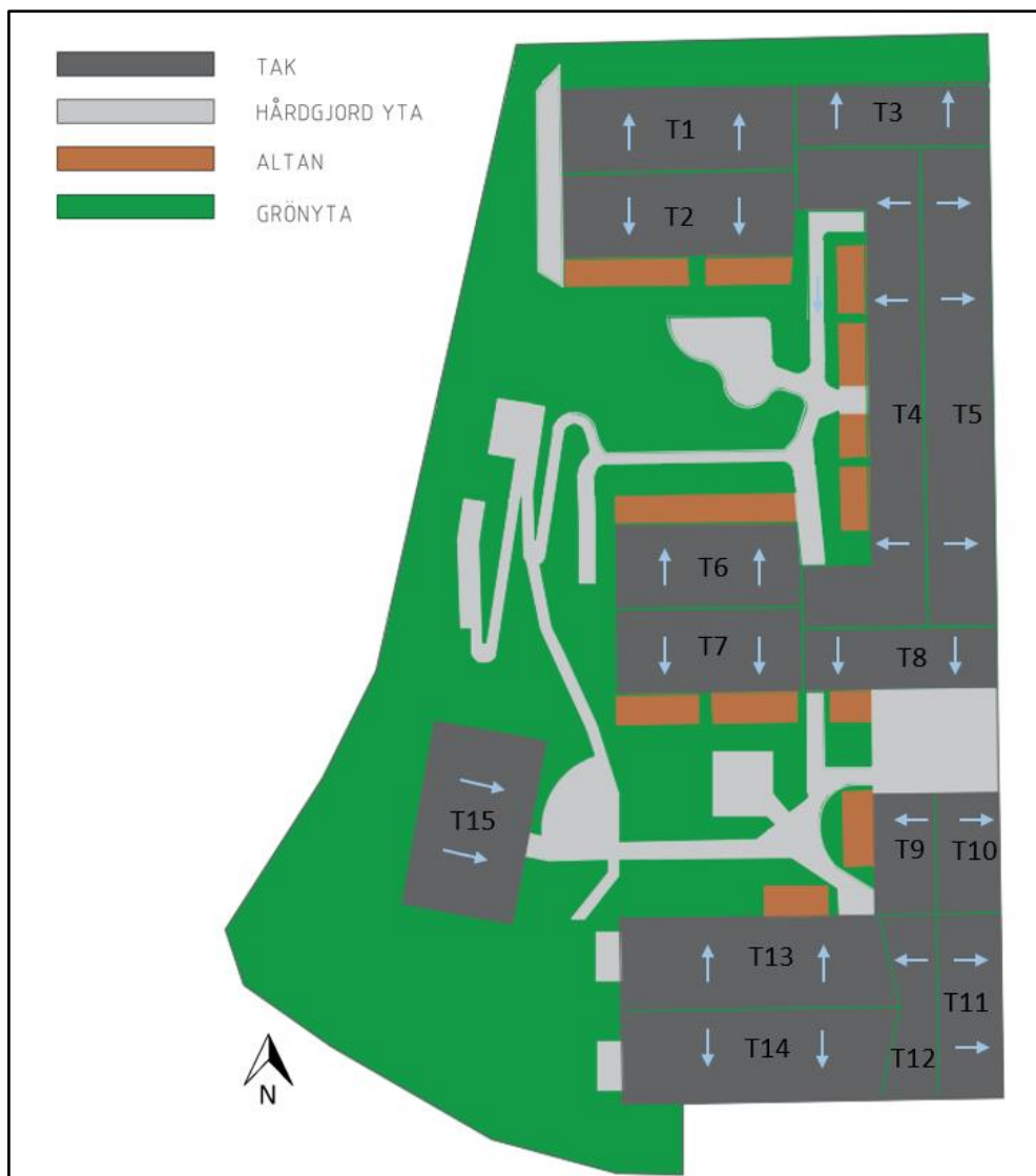
Figur 11 Markanvändning samt uppdelning av takytor för magasinsberäkningar
