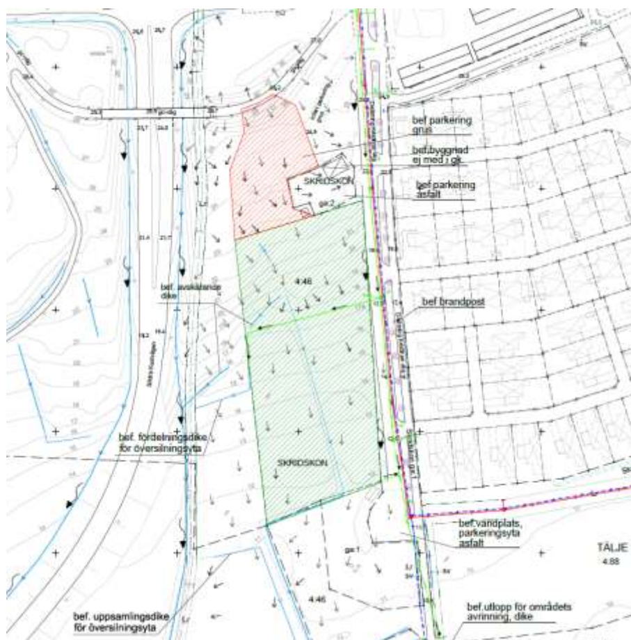
Befintliga förhållanden, dagvatten.
