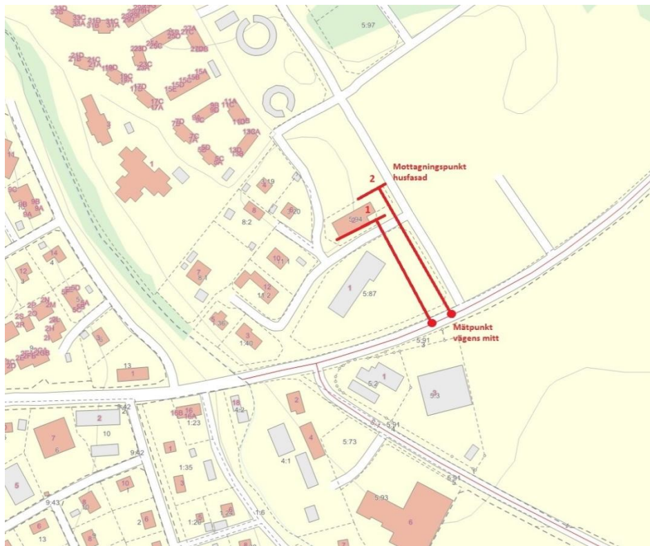
Bild från bullerutredningen som visar mätpunkter och mottagningspunkter vid husfasad
