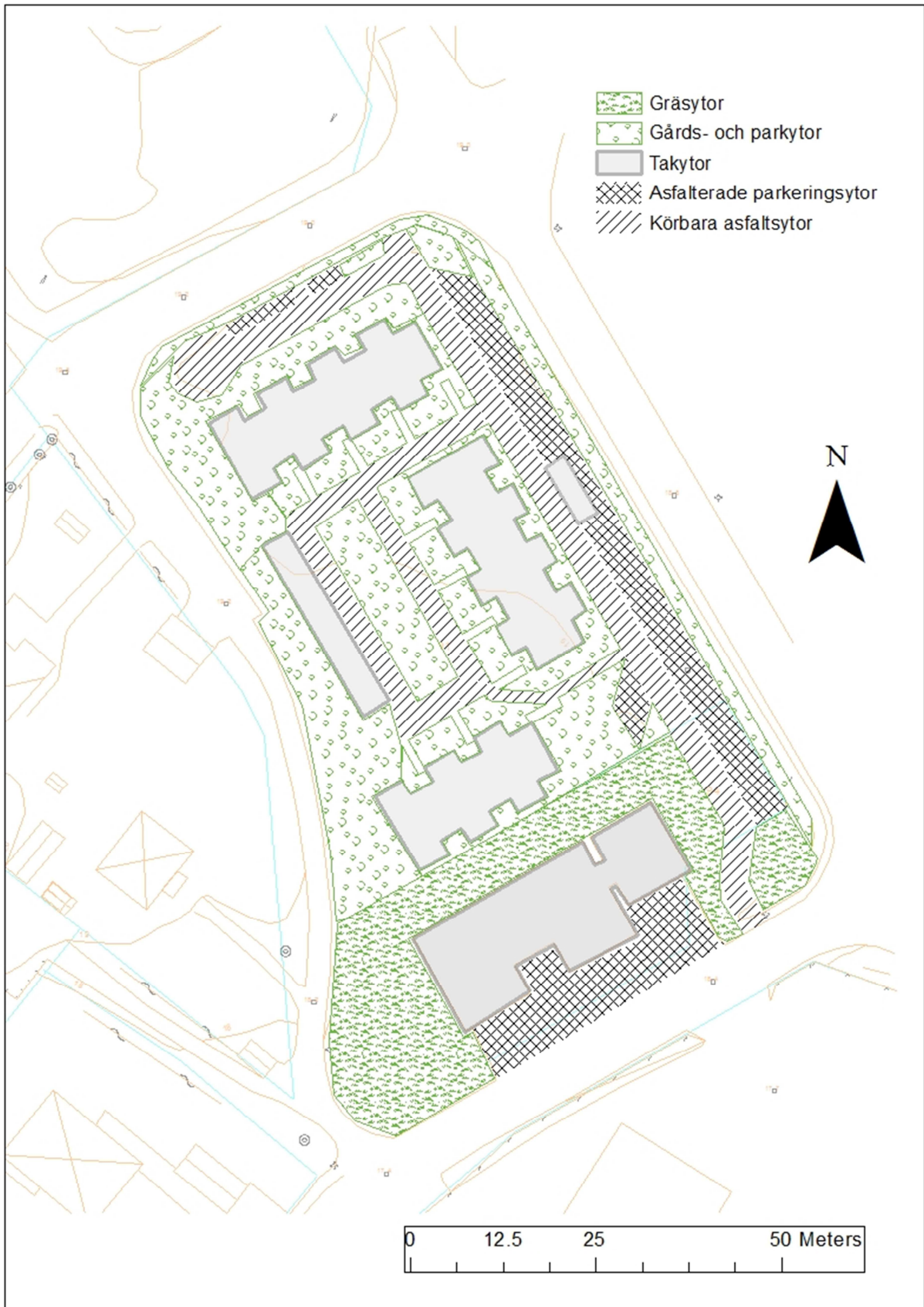
Figur 2-2. Karta över del av fastighet Rimbo-Vallby 5:91 och fastighet Rimbo-Vallby 5:94 med planerad markanvändning: asfalterade/hårdgjorda ytor (gråstreckade och kryssade rutor), takytor (gråa ytor med heldragna linjer), gårds- och parkytor (vita ytor med gröna punkter) och gräsytor (grönvita ytor).
