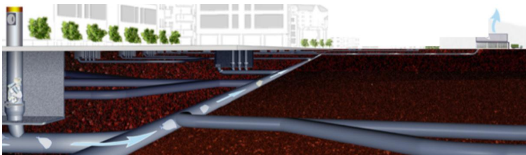
Figur 3 Stationärt sopsugssystem med stålör, Envac.
