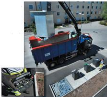
Figur 18: Tömning av underjordsbehållare (Källa: PWS)
