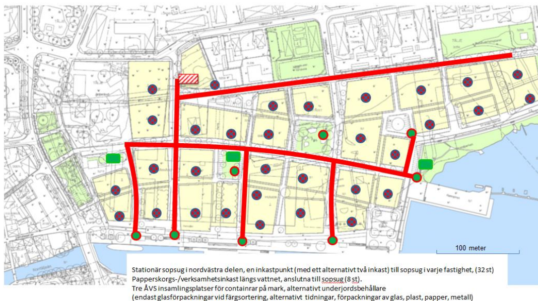
Figur 1 Sopsugsystem med nedkast och terminal, samt tre platser med insamling av glas.
