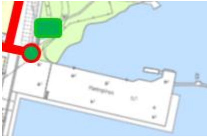
Figur 22 Detalj av marinan med nedkastventil/underjordsbehållare för restavfall (rund) och station för FTI fraktioner/glas (grön fyrkant)
