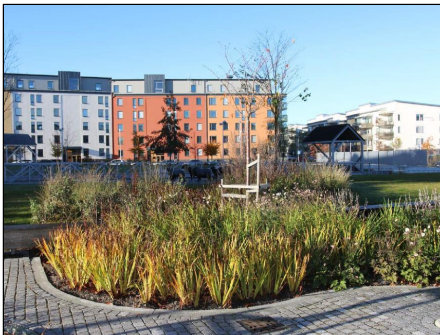
Figur 12. Exempel på nedsänkt växtbädd (Solna stad dagvattenstrategi, 2018)
