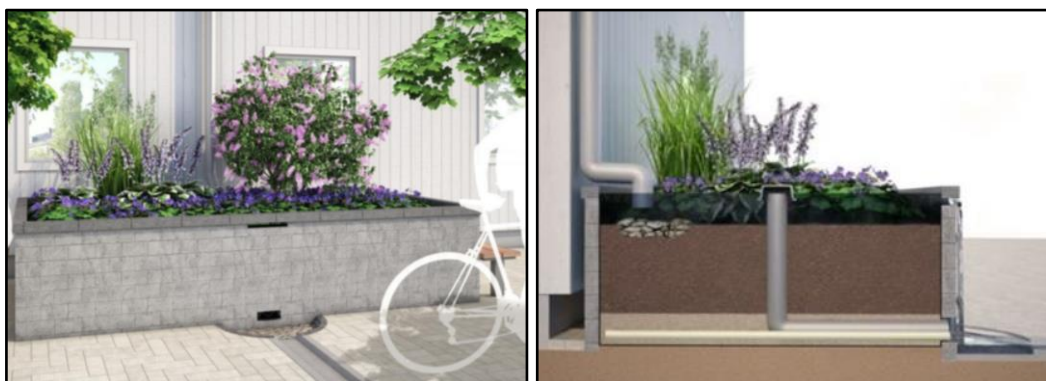
Figur 13 & 14. Exempel på upphöjda växtbäddar som tar emot dagvatten från tak via stuprör (Vinnova, 2014)
