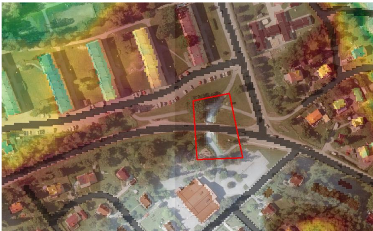
Figur 3 Figuren visar ett utsnitt ifrån terrängmodellen. Den röda polygonen visar ett exempel på en underfart som senare justerades i det hydrauliska beräkningsprogrammet. Notera färgskiftningarna mellan vitt och brunrött inom polygonen för en uppfattning om hur höjddatat har justerats för att ytvavrinning ska kunna passera genom underfarten.
