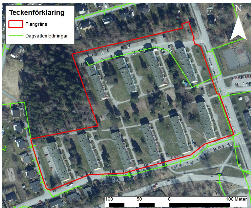
Figur 4 – Dagvattenledningsnät inom och intill detalplaneområdet.
