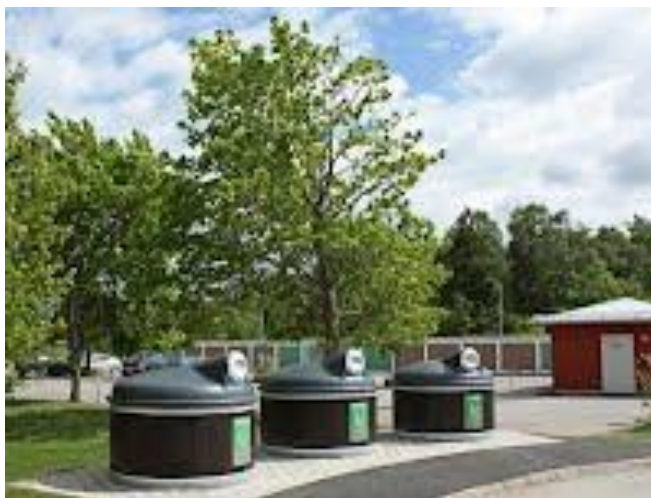
Exempel på moloklösningar – i mark nedsänkta sopfraktionskärl som kan tömmas med anpassat sophämtningsfordon.
