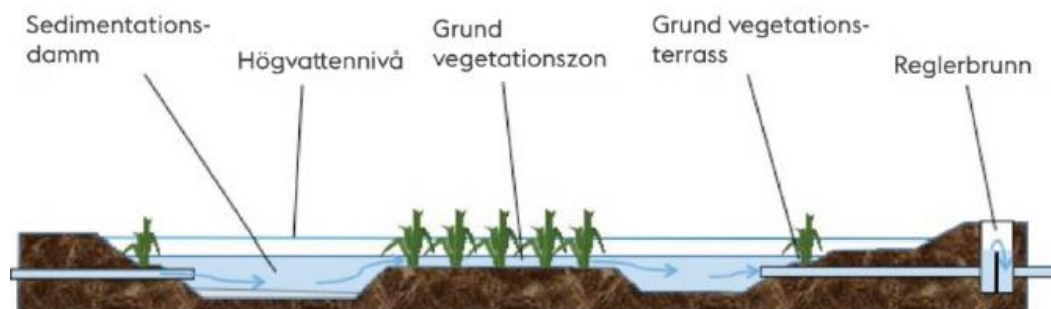
Figur 96 Principskiss för en dagvattendamm, WSP 2019.
