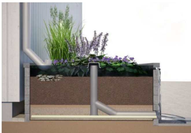
Figur 14. Till vänster: Principskiss av en upphöjd växtbädd (Bildkälla: Kent Fridell och Kristian Klasson, Tengbomgruppen AB.). Till höger: Exempel på upphöjd växtbädd på kvartersmark (Bildkälla: Bara Mineraler)
