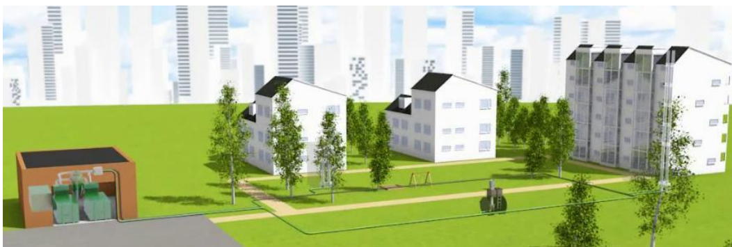
Figur 12 Illustration över stationärt sopsugsystem med inkast och terminal, ej konventionellt Källa MariMatic AB.
