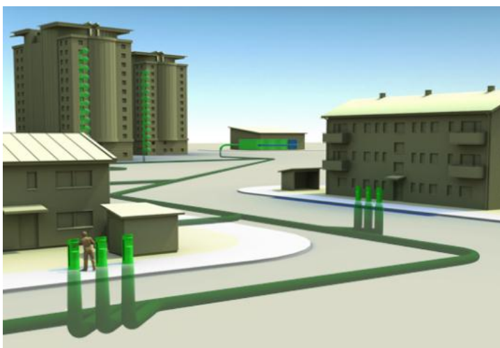
Figur 11: Illustration över stationärt konventionellt sopsugsystem med inkast och terminal. Källa Logiwaste AB.
