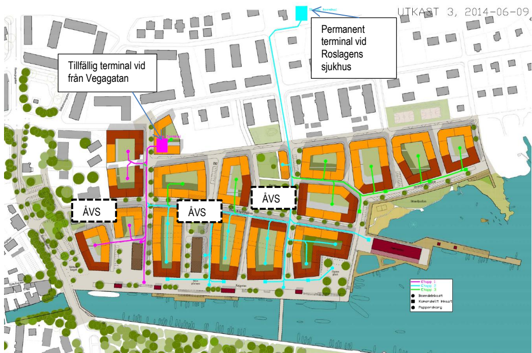
Figur 21: Systemuppbyggnad stationär sopsug, tre etapper från väst till öst: rosa, turkos och grön. Alternativ placering sopsugterminal vid ROS, ett par kvarter norr om illustrationens turkosa kvadrat. Tre ÅVS för förpackningar planeras för det fullt utbyggda området.
