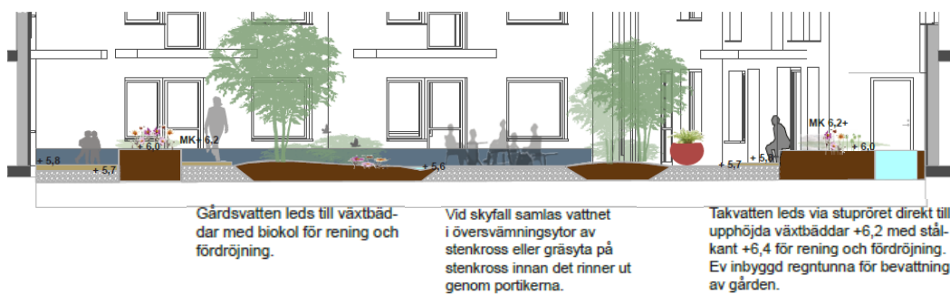
Sektion över innergården med föreslagen dagvattenhantering. Veronika Borg landskapsarkitektur & stadsbyggnad.
