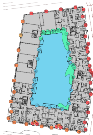
Maximal ljudnivå från vägtrafik, dagtid. Beräknade A-vägda ljudnivåer med hänsyn taget till ett bullerspektrum med frekvensfördelning motsvarande stadstrafik, inkl bussar och andra tunga fordon.
