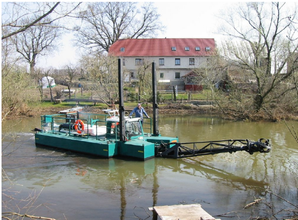
Figur 10. Exempel på en sugmuddringsbåt (Andersson et al, Skötsel av dagvattendammar – en handbok, 2013).
