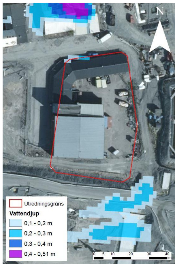
Figur 7. Riskområden för stående vatten vid kraftiga regn (67,5 mm, motsvarande ett 100-årsregn med 60 minuters varaktighet och klimattfaktor 25%). Bakgrund: Ortofoto från Lantmäteriets visningstjänst).
