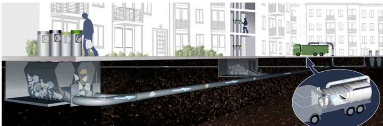
Principvy sopsugssystem, ovan och under mark. Illustration: Envac.
