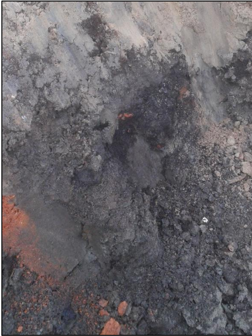
Svart material innehållande PAH-halter över gränsvärdet för farligt avfall.
