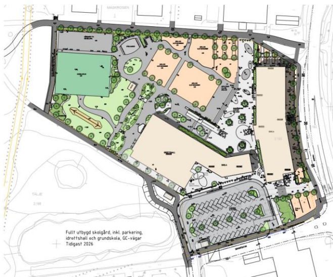
Exempel på möjlig situationsplan med sammanbyggd skola och sporthall i södra delen vid maximalt utnyttjande av byggrätt. Bild: m3D consulting, LBE arkitekt, 2021-09-02
