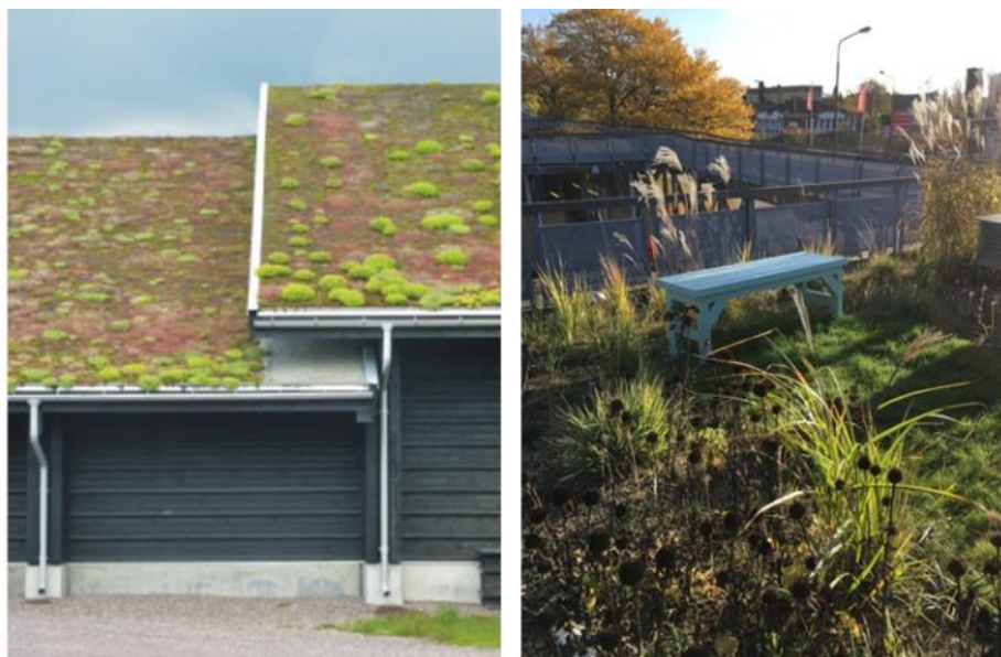
Figur 16. Exempel på tunna (till vänster) och tjocka (till höger) gröna tak.
