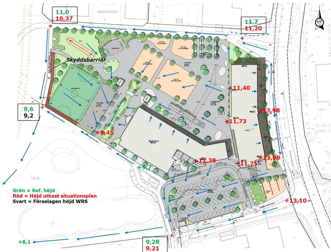
Figur 3. Förslag till sekundära avrinningsvägar för att hantera skyfall från planområdet samt från mark utanför området. Alternativ för idrottshall i söder. Bakgrundsbild: Utkast till situationsplan, erhållen 2021-05-17 (m3D, 2021b).
