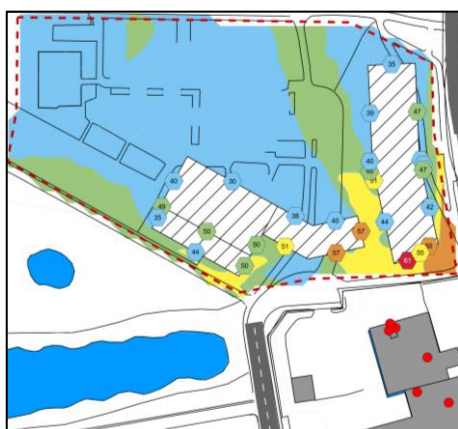
Figur 11. Alternativ C02 - Beräknad ekvivalent ljudnivå 1,5 m över mark för verksamhetsbuller.
