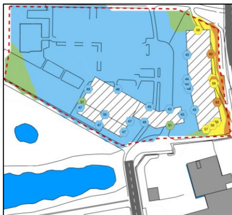
Figur 7. Alternativ C02 - Beräknad ekvivalent ljudnivå 1,5 m över mark för vägtrafik.
