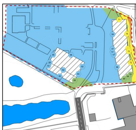
Figur 10. Alternativ D02 - Beräknad maximal ljudnivå 1,5 m över mark för vägtrafik.
