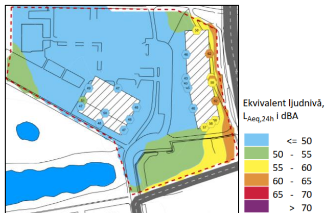
Figur 4. Alternativ D01 - Beräknad ekvivalent ljudnivå 1,5 m över mark för vägtrafik.
