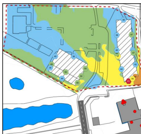
Figur 12. Alternativ D02 - Beräknad ekvivalent ljudnivå 1,5 m över mark för verksamhetsbuller.
