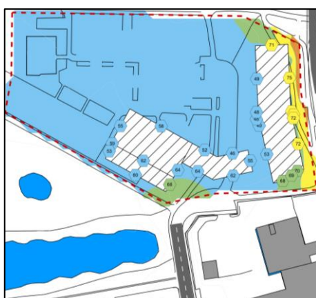
Figur 9. Alternativ C02 - Beräknad maximal ljudnivå 1,5 m över mark för vägtrafik.
