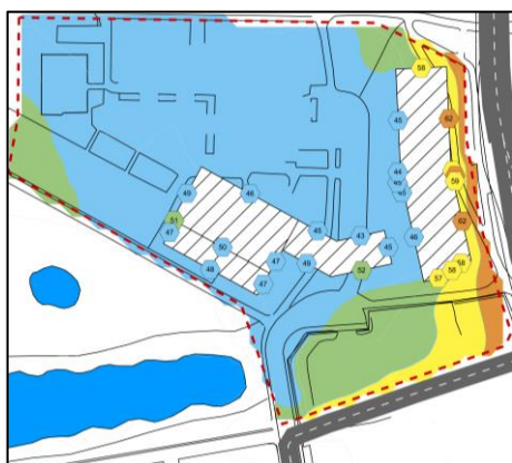
Figur 3. Alternativ C01 - Beräknad ekvivalent ljudnivå 1,5 m över mark för vägtrafik.
