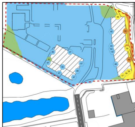
Figur 8. Alternativ D02 - Beräknad ekvivalent ljudnivå 1,5 m över mark för vägtrafik.
