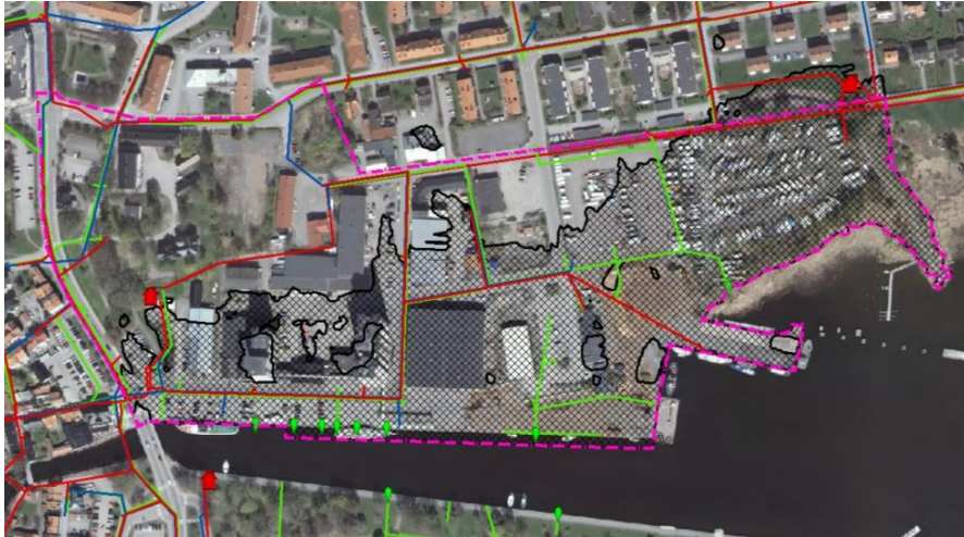
Figur 14. Befintligt ledningsnät och den markyta som översvämmas om havsnivån stiger till +1,5m markerat med svart rutnät.
