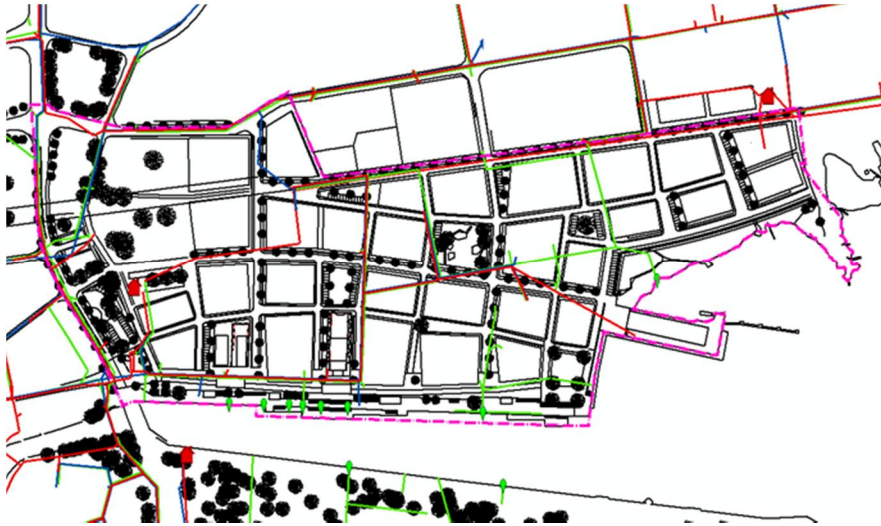
Figur 16. Strukturplanens indelning tillsammans med befintliga VA-ledningar.
