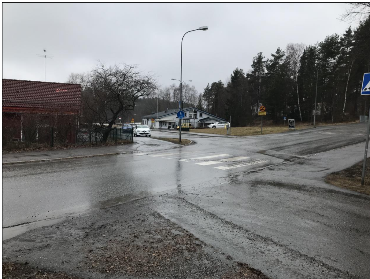
Figur 7-3. Planområdet centralt i bild samt förskolans utsatta läge till vänster. Förskolan ligger i områdets lägsta punkt och det rekommenderas därför inte att leda ytterligare vatten mot denna lågpunkt.
