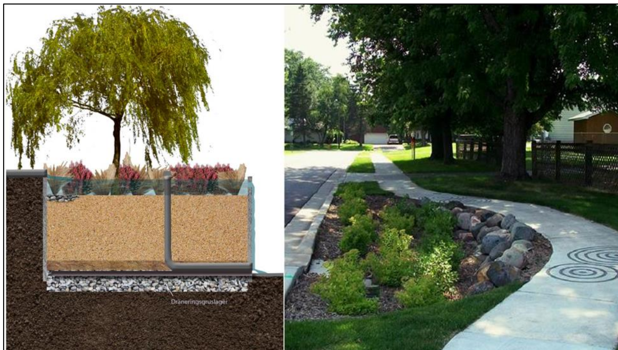
Figur 6-3. Illustration av hur en regnbädd kan byggas upp (Illustration Åsa Wellander och foto från City of Maplewood).
