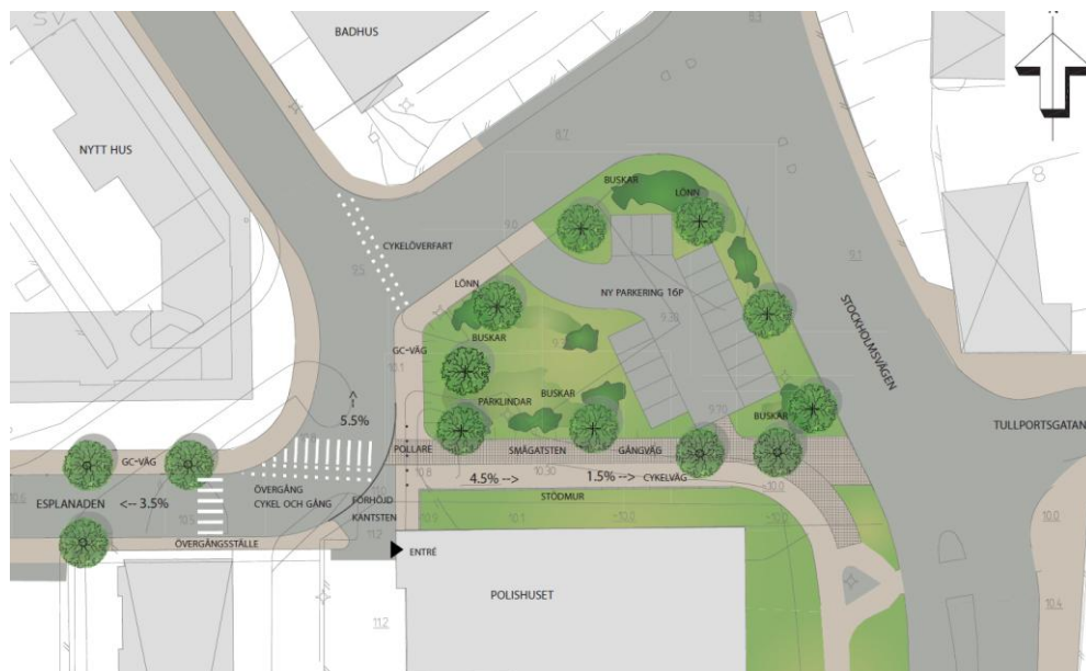
Illustrationsplan som redovisar ny utformning av gatukorsningarna Esplanaden-Trädgårdsgatan/Stockholmsvägen. Utformning är i sitt detaljutförande enbart på förslagsnivå.
