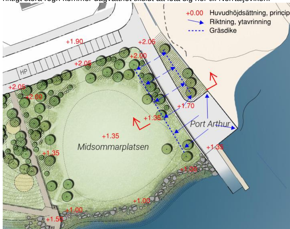
Figur 36 Preliminära principer kring dagvattenhanteringen i Östra Galären (Illustration av SYDVÄST arkitektur och landskap).
