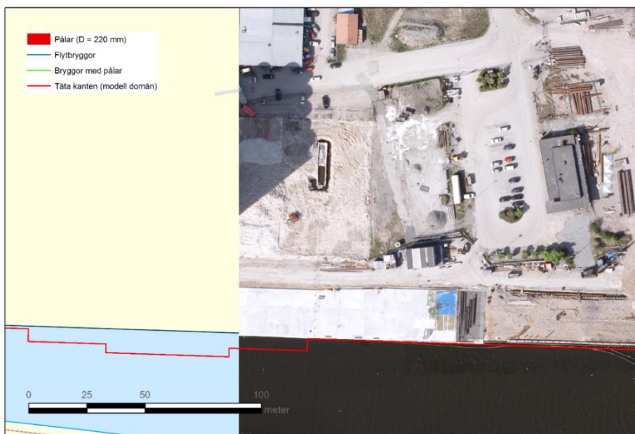
Figur 2-6 Framtida byggnationer i inre hamnen – landbegränsning, bryggor med pålar, flytbryggor
