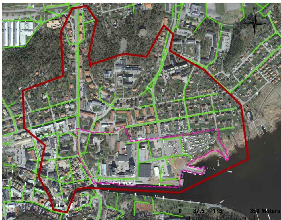
Figur 1. Hamnens skelettplan (rosa linje) och avrinningsområdet (röd linje). Bilden visar även befintligt dagvattennät.
