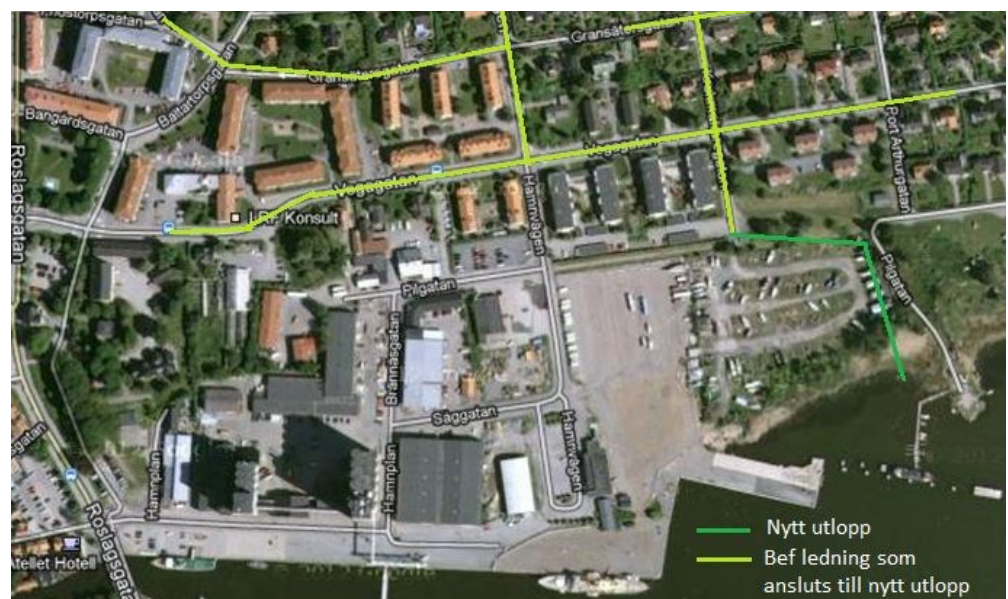
Figur 18. Alternativt utlopp för dagvattenavledning från området norr om Hamnens skelettplan.
