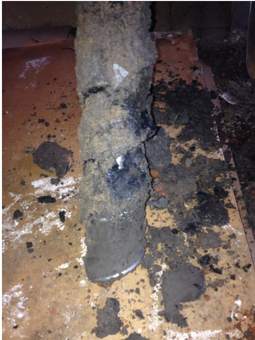
Bild 4A: BP2, 0,5-1,0 m Provtagning av fyllning med bark och med stickande lukt.
