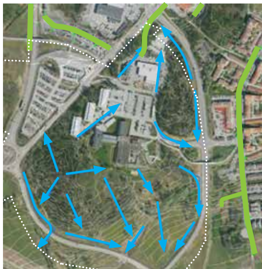
Blå flödespilar visar avrinningsvägarna för dagvattnet idag. Gröna linjer är befintligt dagvattensystem. (Illustration från Dagvattenutredning, Ramböll, 2017)
